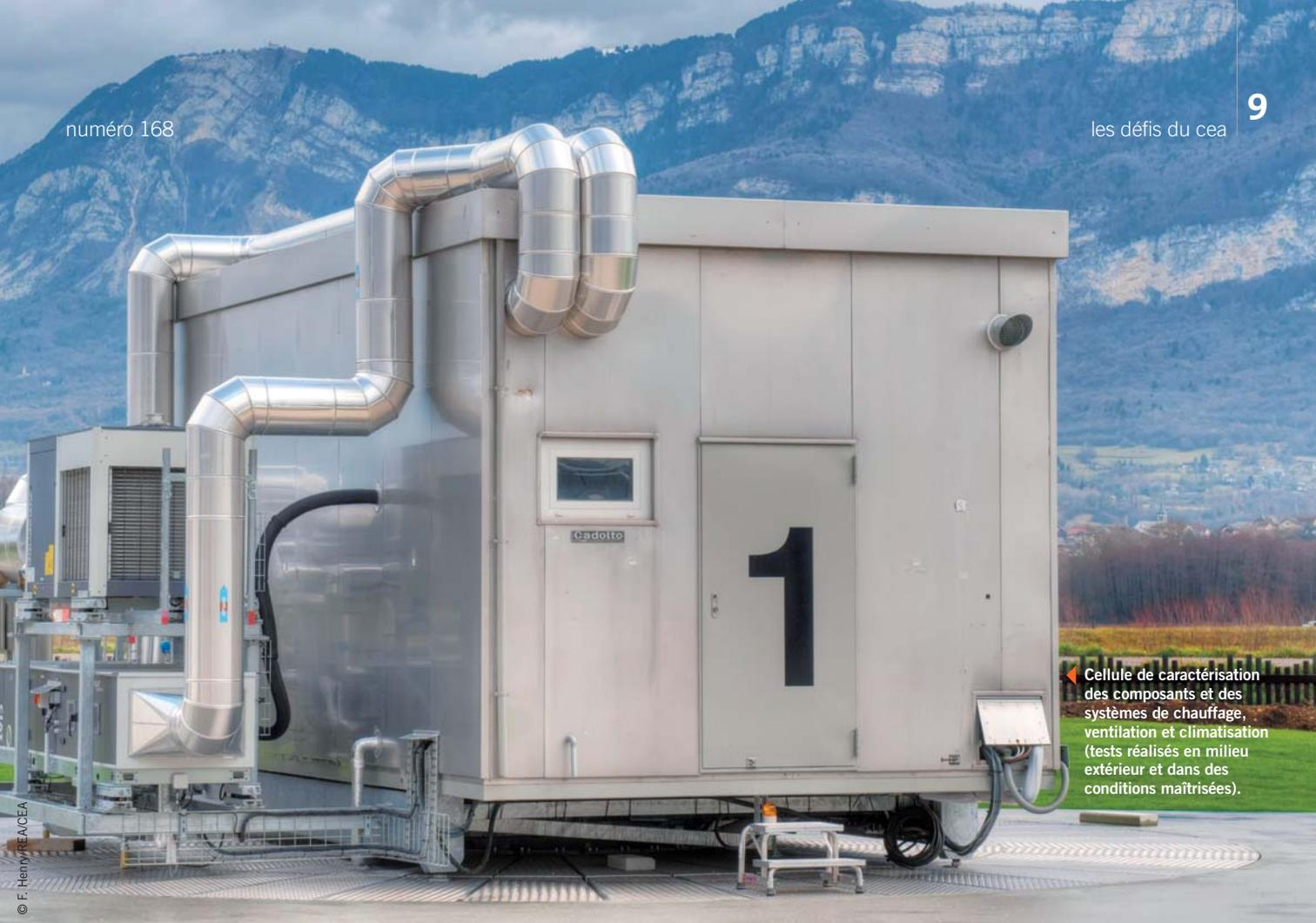
◀ Cellule de caractérisation des composants et des systèmes de chauffage, ventilation et climatisation (tests réalisés en milieu extérieur et dans des conditions maîtrisées).
