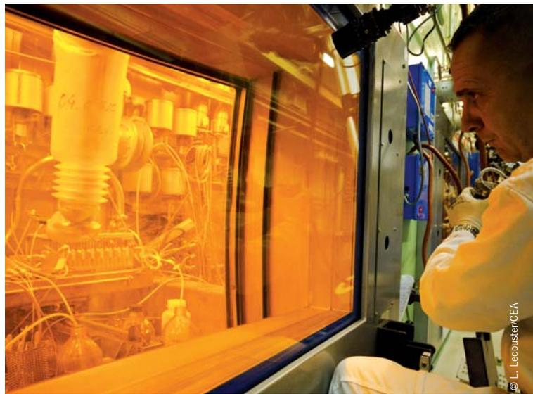
▲ Cellule blindée du laboratoire Atalante au centre CEA de Marcoule, où sont notamment développés les combustibles pour les réacteurs de 4<sup>e</sup> génération.
