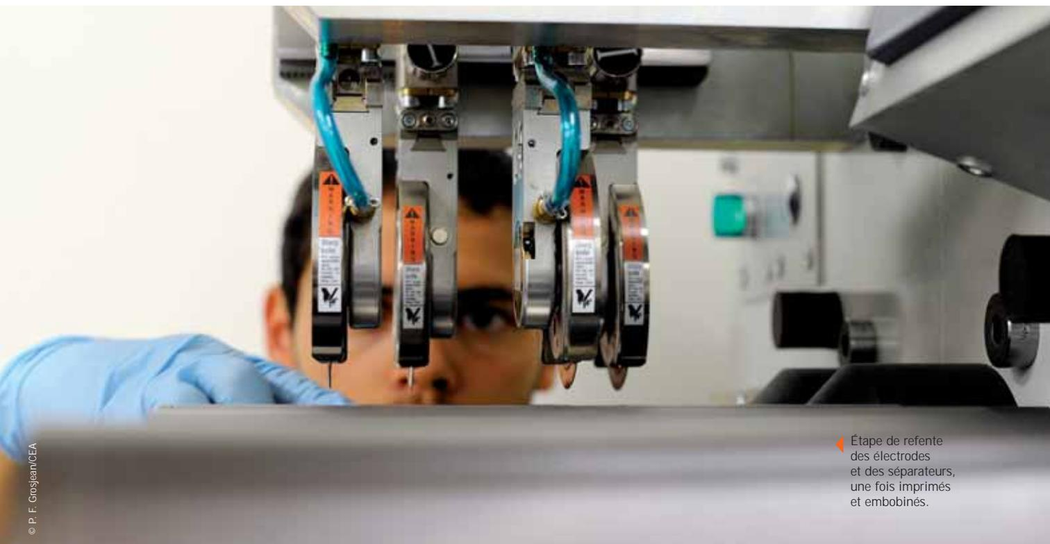
◀ Étape de refente des électrodes et des séparateurs, une fois imprimés et embobinés.
