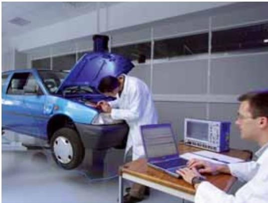
◀ Étape du monitoring qui consiste en l'instrumentation d'un véhicule (ici le modèle Citroën AX) pour étudier ses performances énergétiques.
