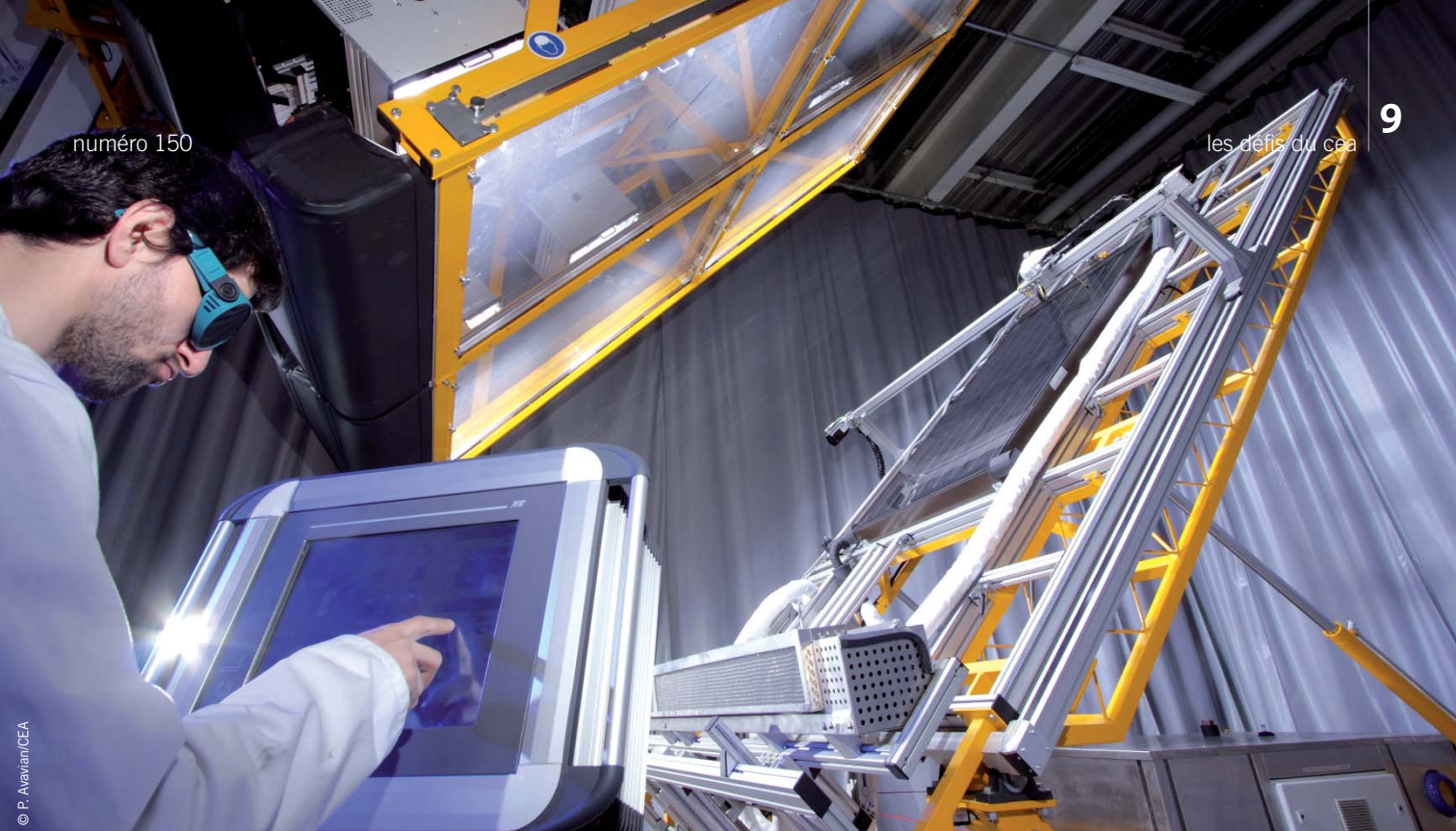
▲ Banc d'ensoleillement artificiel de l'Ines, pour tester les performances des capteurs solaires thermiques.
