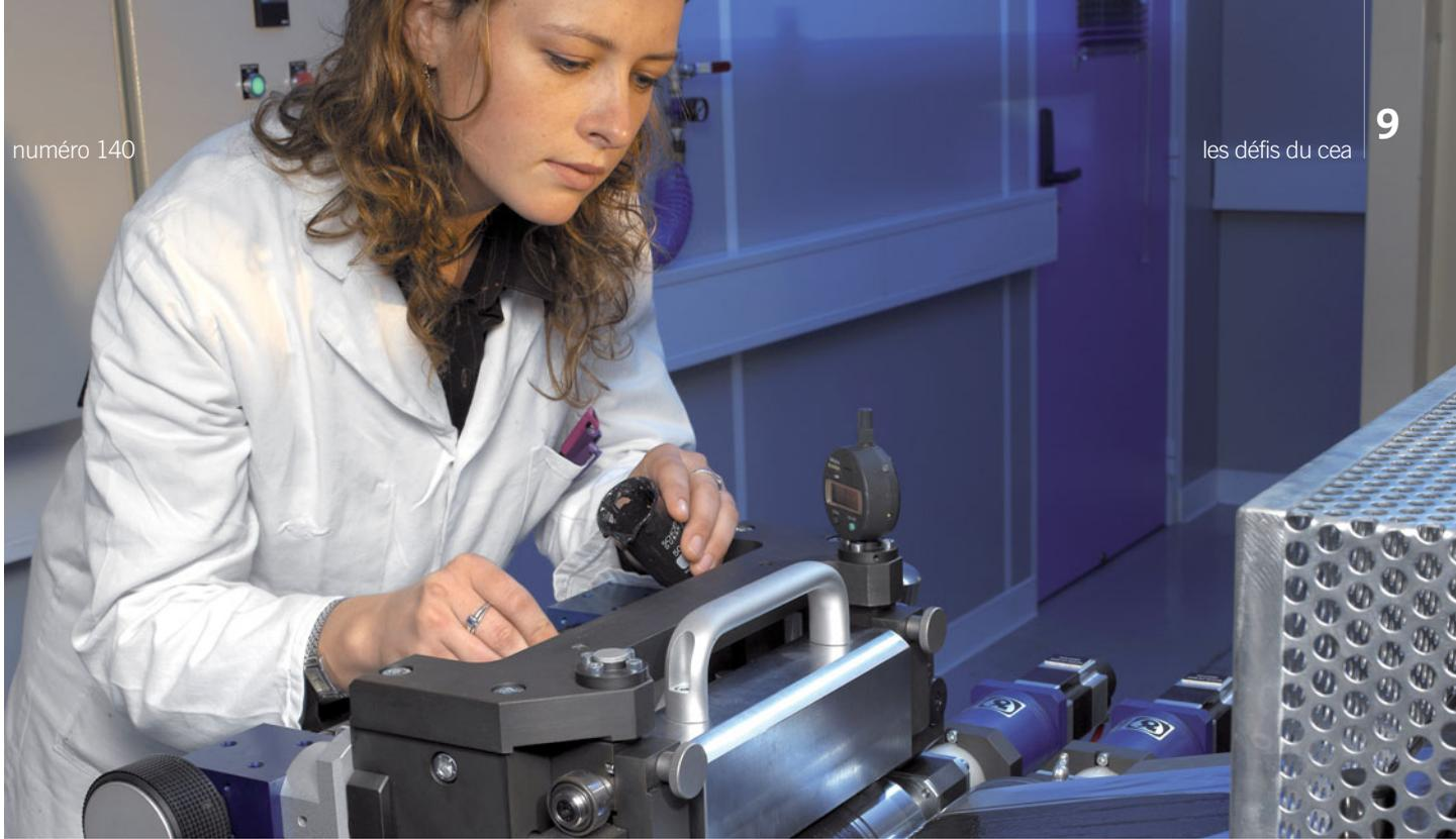
▲ Réalisation des électrodes et membranes des batteries lithium par enduction d'une encre sur un support souple.
