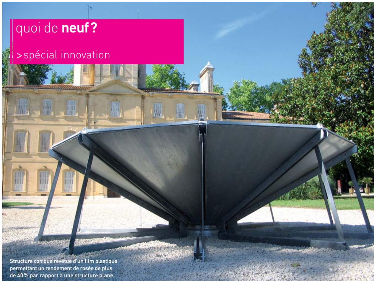
Structure conique revêtue d'un film plastique permettant un rendement de rosée de plus de 40 % par rapport à une structure plane.
